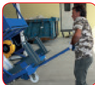
Sistema di carico su automezzo con slitta e barra di ribaltamento
